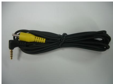
AV out cable
